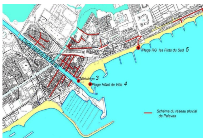
Fig 5 Débouché du Lez et réseau séparatif pluvial de Palavas totalisant dix évacuations dans le fleuve et une évacuation vers la plage
