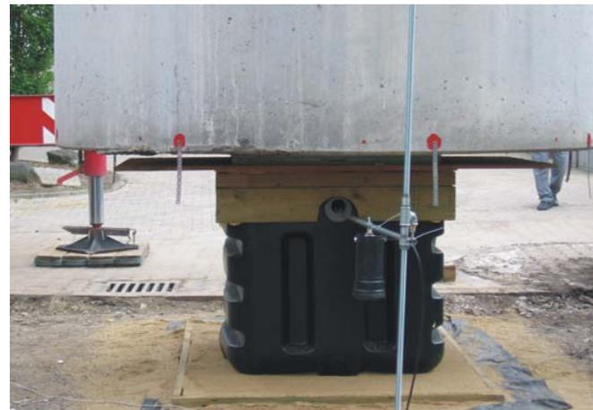
Charge jusqu'à la rupture: 1,9 T
